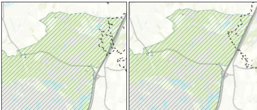
Figuur 6 Verandering van de gemiddeld hoogste grondwaterstand (rechts) en de gemiddeld laagste grondwaterstand GLG (rechts) als gevolg van een drinkwaterwinning Beilen van 5 miljoen m 3 per jaar (ten opzichte van geen winning) in het Dwingelderveld.
